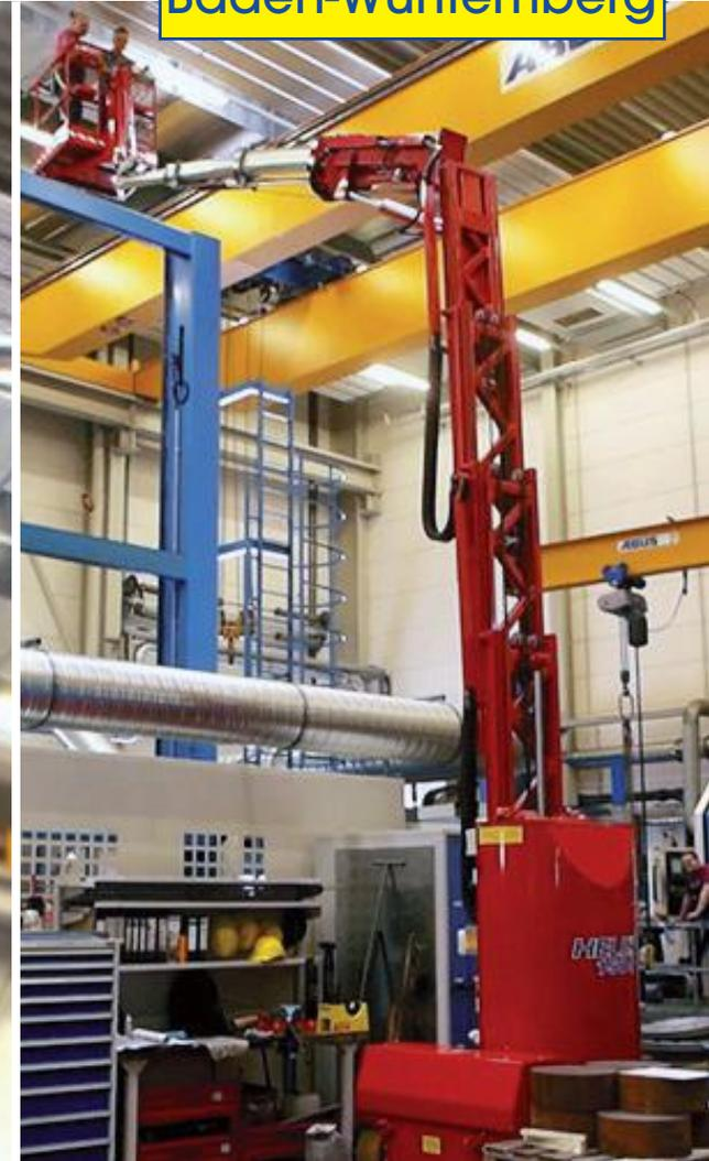
Es handelt sich um eine elektrisch betriebene, kompakte, selbstfahrende Gelenk-Teleskop-Arbeitsbühne mit Korbarm (Arbeitshöhe bis 15 m), welche speziell für Wartungs- und Instandhaltungsarbeiten in beengten Bereichen entwickelt wurde.
