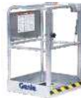
Arbeitskorb mit klappbarem Einstieg Standard: 69 x 66 x 114 cm
